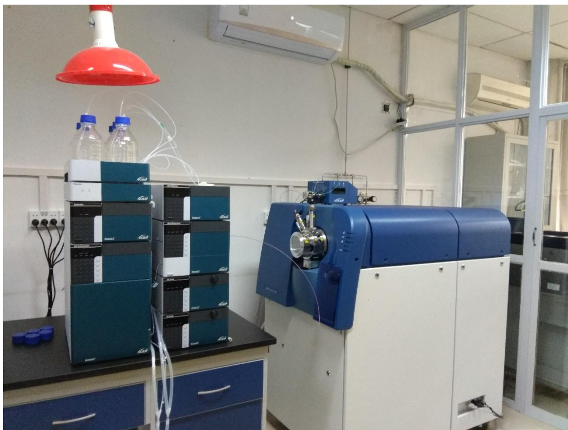
AB Sciex ExionLC- Q-TOF 5600+ 超高效液相色谱-四极杆飞行时间质谱
