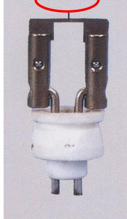
电子枪有热发射、冷发射和场发射三种。最普通的是热发射，即一根发夹形钨丝，通过电流加热后，发射出电子束，成为电源的光源。
